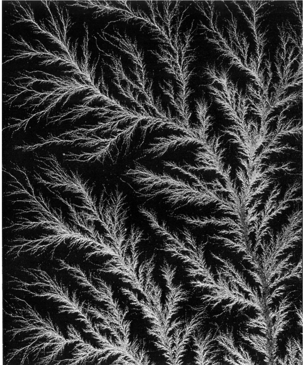
Abb. 7: Plexiglasplatte nach Elektronenstrahl-Beschuss. © Manfred Kage (Peitgen/Jürgens/Saupe 1992, S. X)
